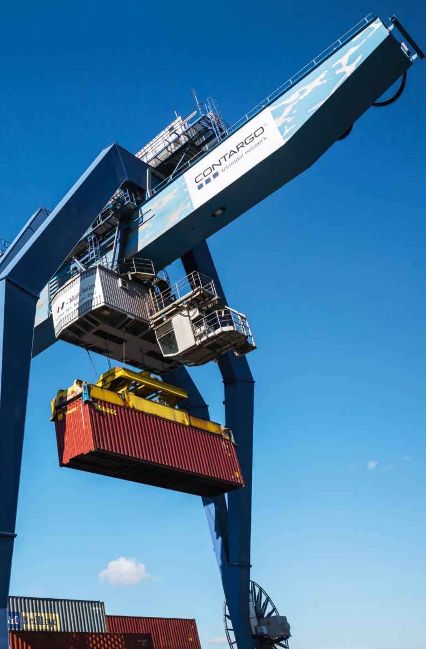
Mit einer Höhe von 36 Metern ist der auffällig blau-weiß lackierte Containerkran der KW-Kranwerke ein Blickfang im Mannheimer Hafen. Das stählerne Kraftpaket bewegt mühelos bis zu 55 Tonnen zwischen Schiff, Schiene und Lkw.
